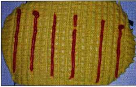
Abb. 5: Korrekt vorbereitetes, knetbares Material mit gleichmäßig verteiltem Härter
