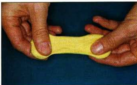
Abb. 6: Auseinanderziehen des Silikons gewährleistet richtiges Durchmischen, da der Härter nur an der Oberfläche adsorbiert wird.
