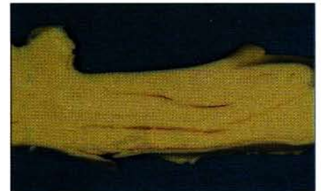
Abb. 4: Blättereartige Struktur eines K-Silikons (Resultat falscher Anmischweise)
